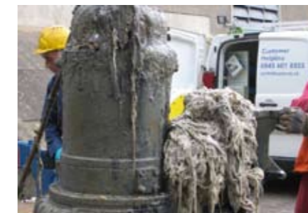
10 pav. Įprastinės užkėmiančios medžiagos, pašalintos iš siurblio (šaltinis: „Scottish Water“)
